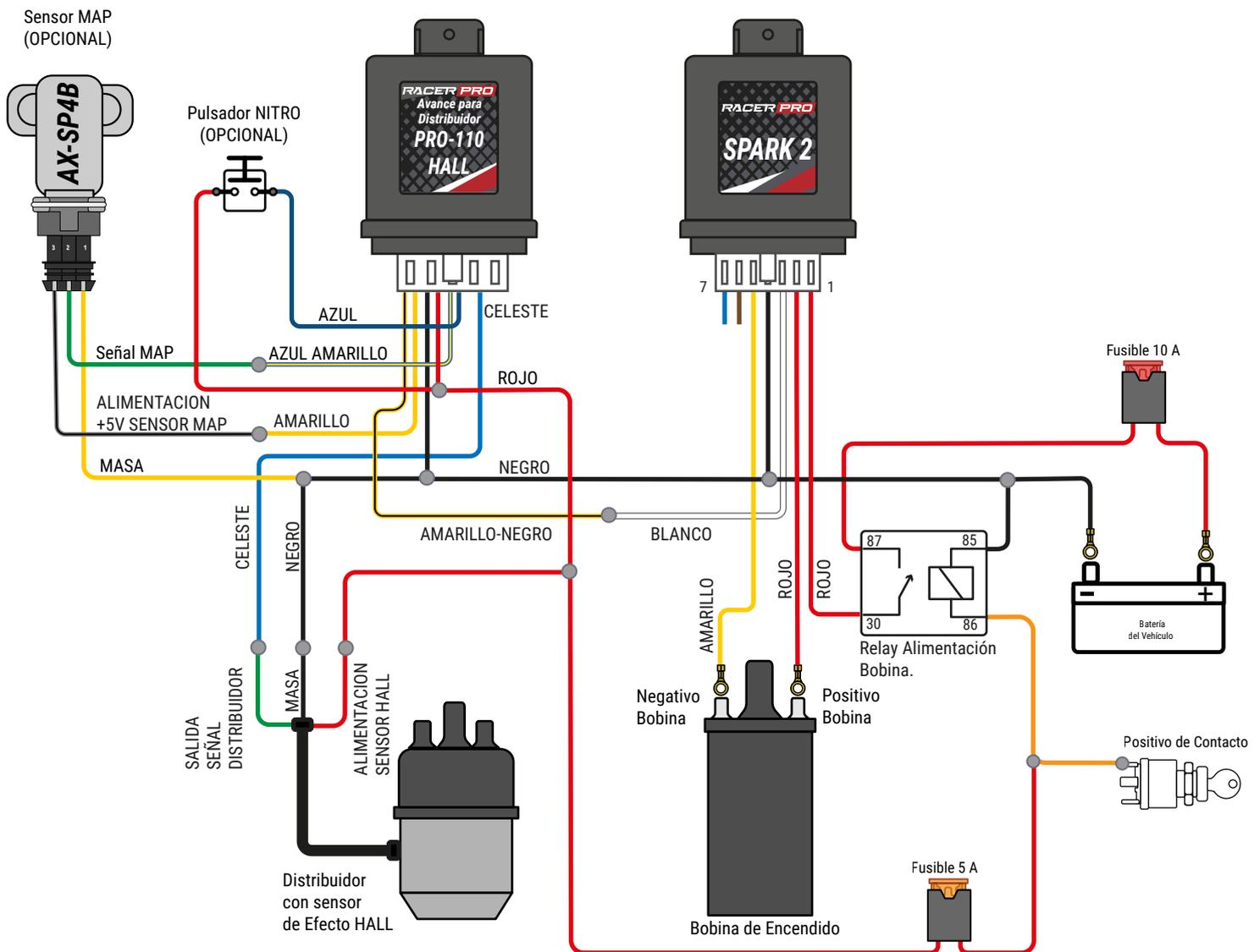
Conector Cableado Mazo PRO-110-HALL visto desde el lado en que salen los cables.
