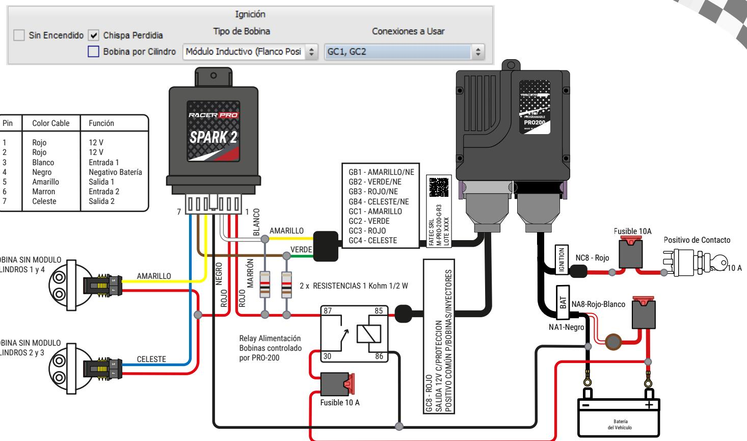
Ejemplo conexionado 2 bobinas conectadas en GB1 y GB2.
